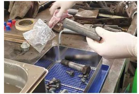
Reinigung mit STAR US 6 im Ultraschallreinigungsgerät
