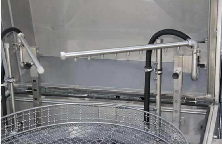
HTW-II Max Eco – höhenverstellbarer Düsenstock für Reinigung und Luftdusche
