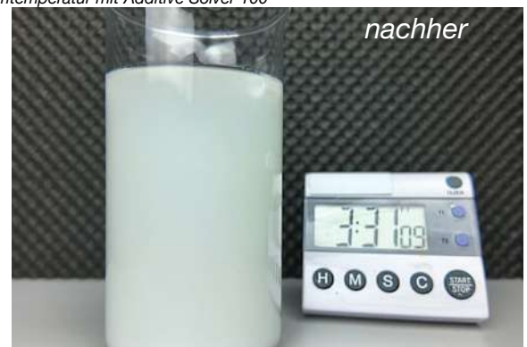
Auflösen von Stützmaterial bei Raumtemperatur mit Additive Solver 100
