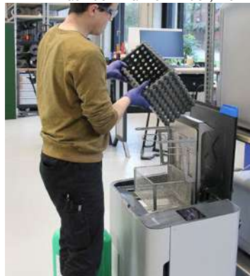
Nach dem Harz-3D-Druck, nicht ausgehärtete Harze in Waschstation abreinigen.
