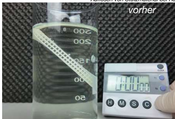
Auflösen von Stützmaterial bei Raumtemperatur mit Additive Solver 100
