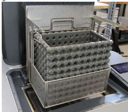
Nach dem Harz-3D-Druck, nicht ausgehärtete Harze in Waschstation abreinigen.
