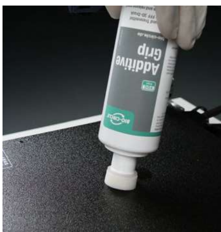
3D-Haft- und Trennmittel auf Druckbett auftragen.
