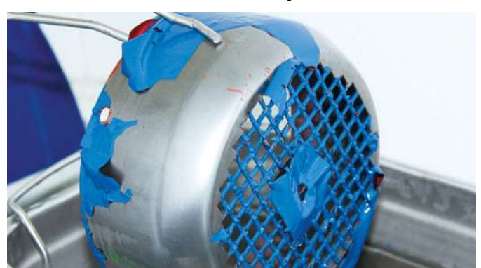
Mit PROLAQ L US Lackentfernung im Ultraschallbad
