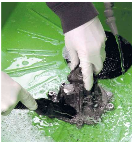
Reinigung överschmutzter Teile im BIO-CIRCLE Teilewaschtisch
