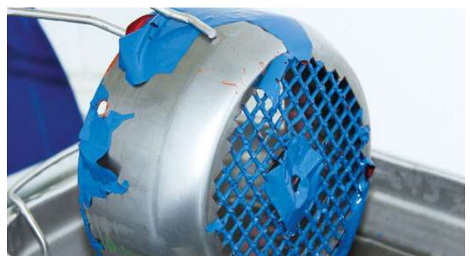
Mit PROLAQ L US Lackentfernung im Ultraschallbad
